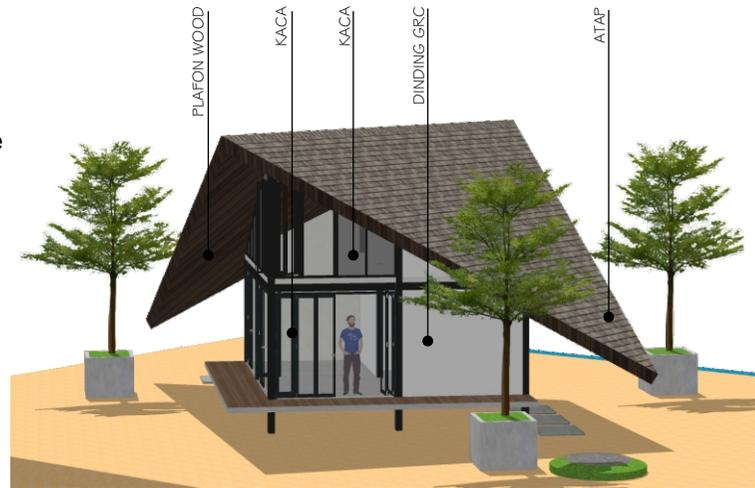
Pondasi yang di gunakan pada bangunan cottage ada lah pondasi footplat dan untuk strukturnya sendiri menggunakan struktur baja begitu juga dengan atapnya, dindingnya sendiri menggunakan GRC
