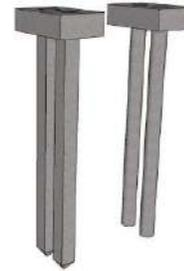
Pondasi tiang pancang yang mampu membuat bangunan lebih kokoh dan mampu menyalurkan beban konstruksi ke bagian tanah paling dalam sehingga lebih stabil.
