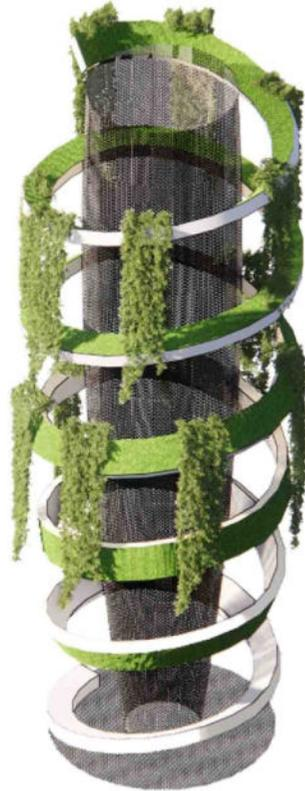
VERTICAL GARDEN MENGGUNAKAN RANGKA BAJA YANG DITANAM DENGAN STRUKTUR STRAUSS PILE DENGAN SISTEM PERAIRAN SPRINKLER IRRIGATION PADA TENGAH SPIRAL TOWER
