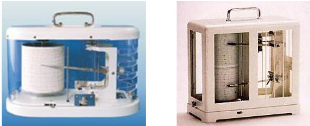
Gambar 2.22 Thermograph dan Thermohygrograph
