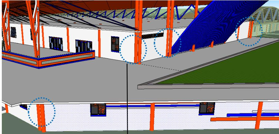
Kolom bulat yang memiliki dilatasi kolom, dengan jarak kolom 10 meter
