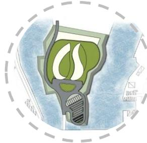
Bentuk bangunan mengikuti pola angin untuk mengurangi beban struktur bangunan
