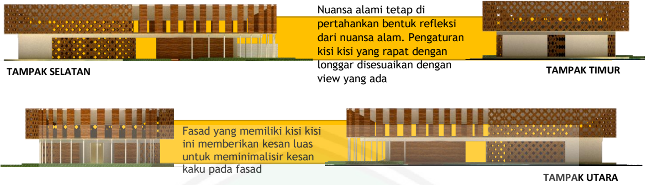
Gambar 6.24. Tampak bangunan masjid Sumber : Hasil analisis, 2019
