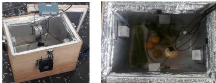
Gambar 3. 2 Bentuk Bagian Luar Dan Dalam Dari Sistem Kotak Pendingin
