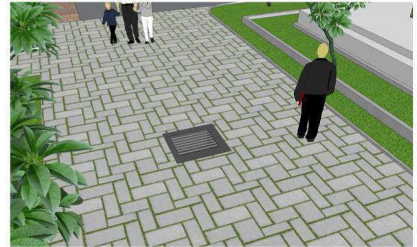
Terdapat biopori pada area-area tertentu yang berfungsi mengatasi genangan air. Pada area pejalan kaki juga menggunakan paving blok untuk mempermudah resapan air hujan.
