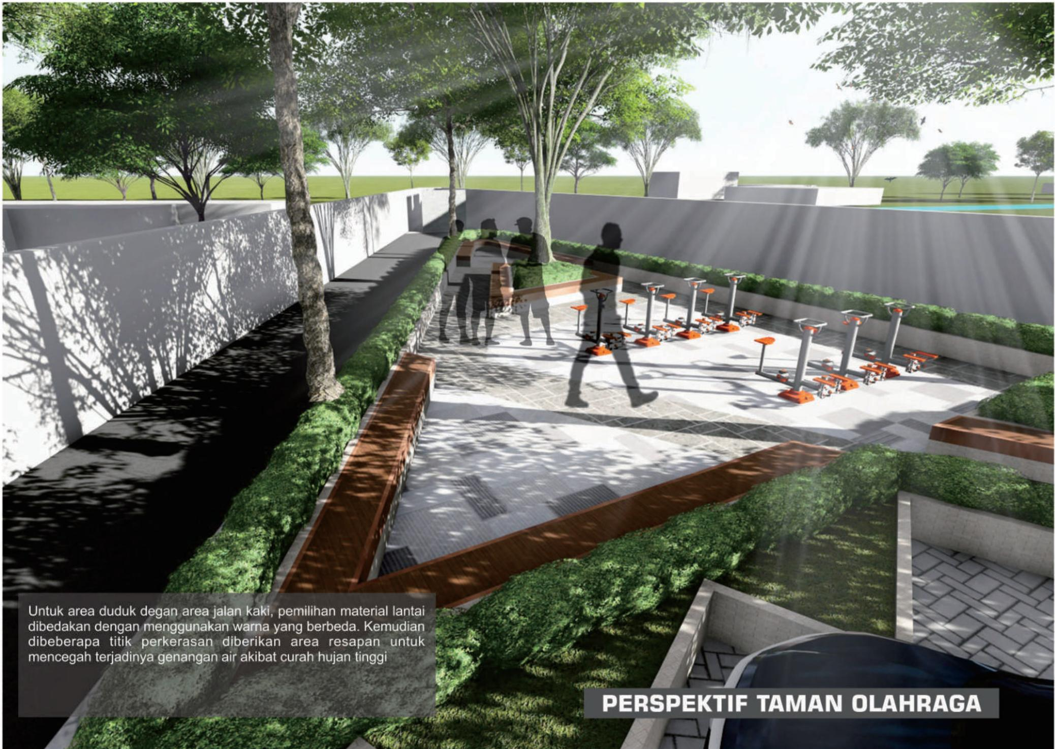
Untuk area duduk dengan area jalan kaki, pemilihan material lantai dibedakan dengan menggunakan warna yang berbeda. Kemudian di beberapa titik perkerasan diberikan area resapan untuk mencegah terjadinya genangan air akibat curah hujan tinggi
