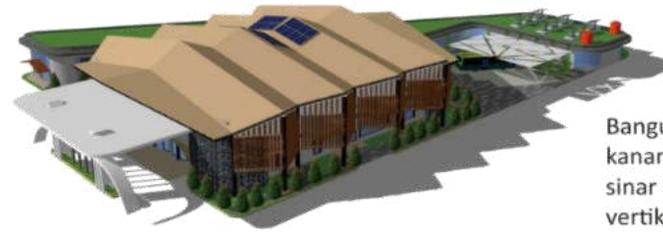
Bangunan diberi shading device disisi samping kanan kiri yang secara tidak langsung mereduksi sinar matahari yang masuk. Shading berbentuk kisi vertikal dengan ditopang dengan tiang pancang.
