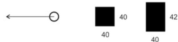
Menggunakan struktur balok penyangga dengan ukuran 42x40 cm yang mampu menyokong kekuatan atap dengan bentuk kolom 6 m
