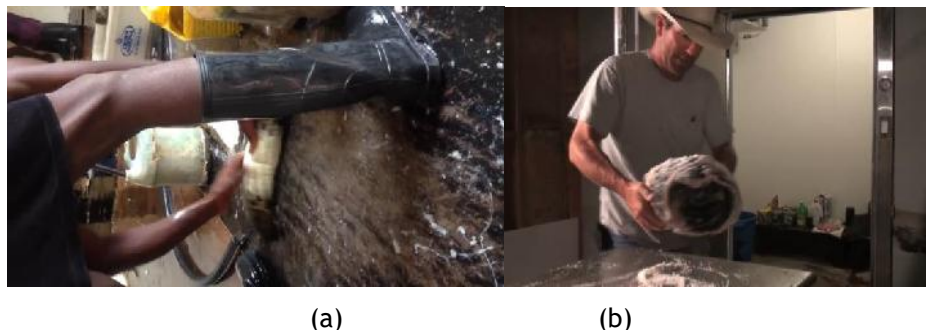
Gambar 2.15 (a) Proses pencucian kulit buaya (b) proses penggaraman kulit buaya
