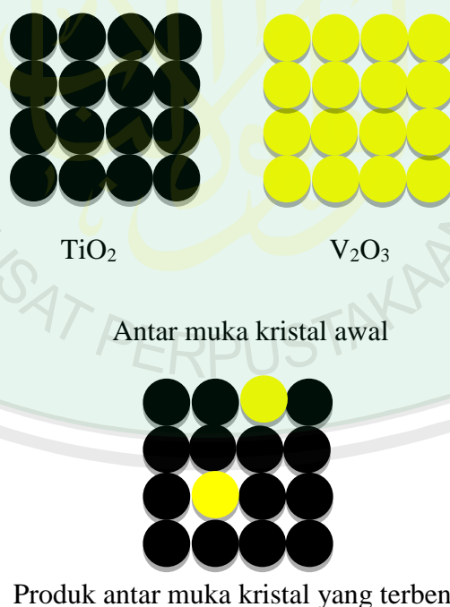
Gambar 4.1 Skema proses difusi kation yang terjadi setelah pemberian panas
