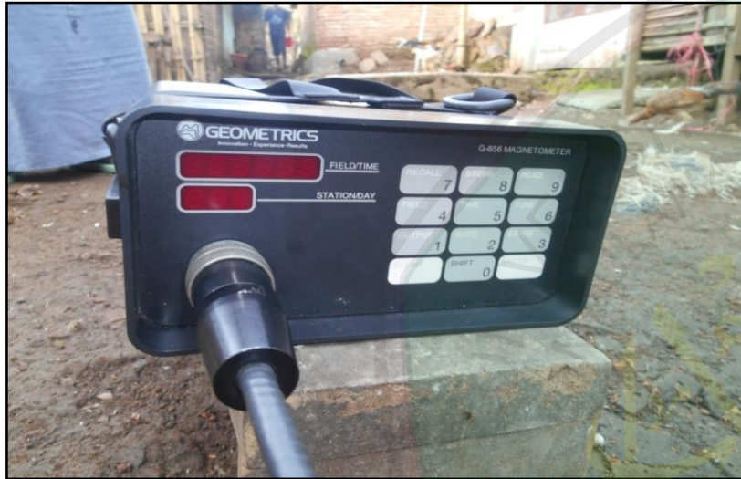
Gambar 8 Intrimentasi utama yang digunakan dalam penelitian metode geomagnetik Base Magnetometer (a). dan Field Magnetometer (b)
