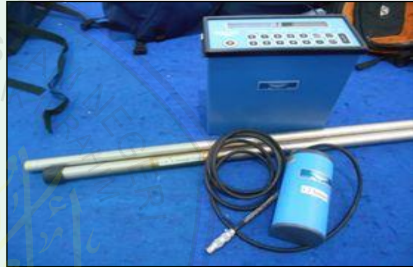
Gambar 8 Intrimentasi utama yang digunakan dalam penelitian metode geomagnetik Base Magnetometer (a). dan Field Magnetometer (b)
