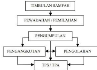
Gambar 2.33 Skema Teknik Operasional Pengolahan Persampahan (Sumber: Rizaldi, 2008)
