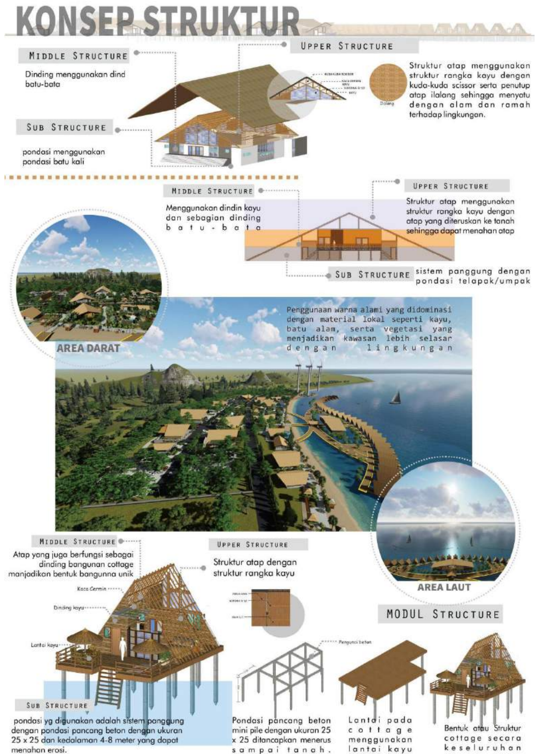
Gambar 6.6 Konsep Struktur (Sumber: Analisis Pribadi, 2021)
