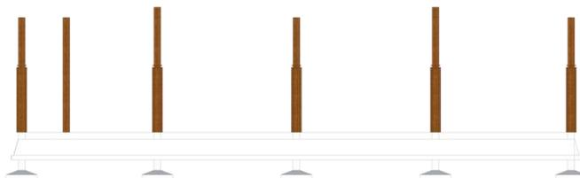
Pondasi setapak digunakan karena untuk kekuatan struktur bentang lebar yang satu lantai di padukan dengan pondasi menerus pada dinding-dindingnya.
