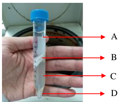
Gambar 4. 2 Hasil VCO setelah pemisahan dimana A (VCO), B (Protein), C (Air) dan D (Padatan)
