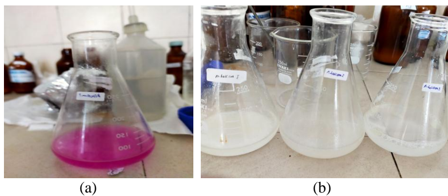
Gambar L.8 Uji bilangan penyabunan: (a) sebelum titrasi; dan (b) sesudah titrasi
