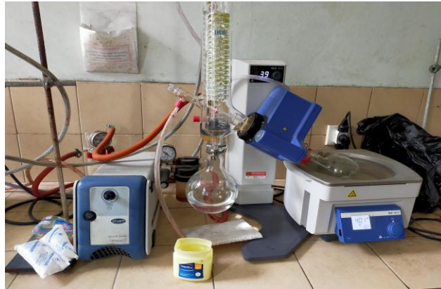
Gambar L.3 Proses penguapan sisa pelarut menggunakan rotary evaporator
