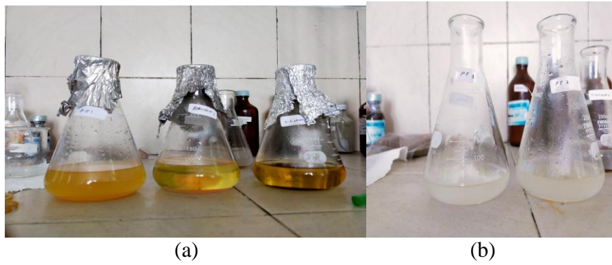
Gambar L.7 Uji bilangan iodin: (a) sebelum titrasi; dan (b) sesudah titrasi
