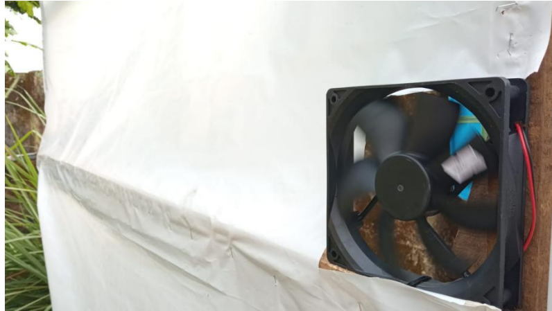
Gambar 4. 13 Ouput pengaturan suhu berupa kipas
