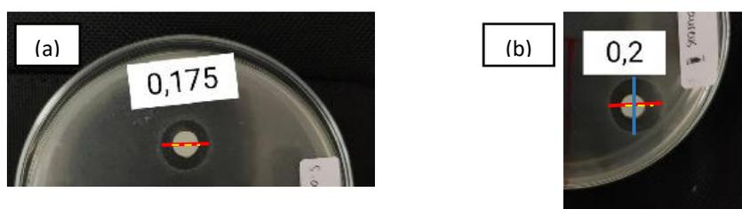
Gambar 4.6 Pengukuran zona hambat (a) berbentuk lingkaran (b) tidak berbentuk lingkaran
