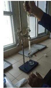
Pemasukan sampel pada kolom
