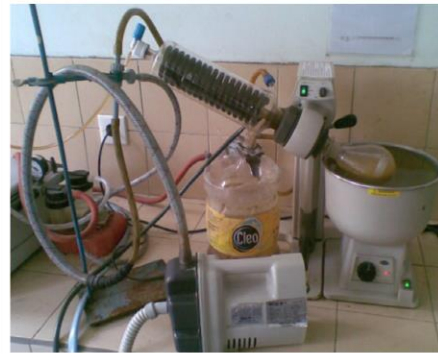
Larutan yang dipekatkan dengan Rotary vakum evaporator
