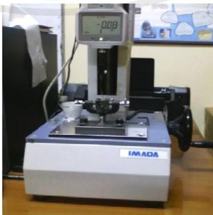
Gambar 3.2 Alat Uji Kekuatan Tarik *Universal Tensile Strength*
