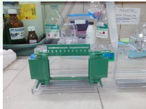
Pembuatan gel elektroforesis
