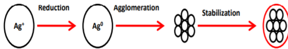
Gambar 2.4. Mekanisme sintesis nanopartikel perak (AgNps)
