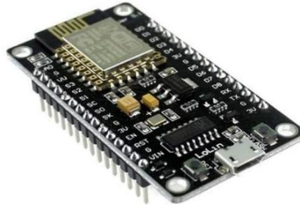
Gambar 2.1 Modul Nodemcu ESP8266
