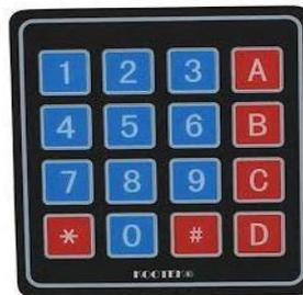
Gambar 2.4 Modul Keypad 4 x 4
