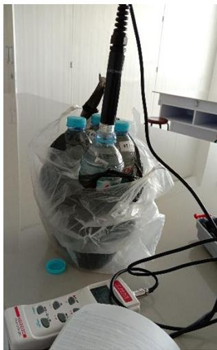
Pengukuran oksigen terlarut air
