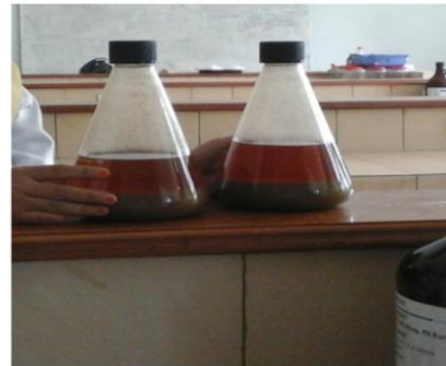
serbuk biji kelengkeng dimaserasi dengan pelarut etanol 95%
