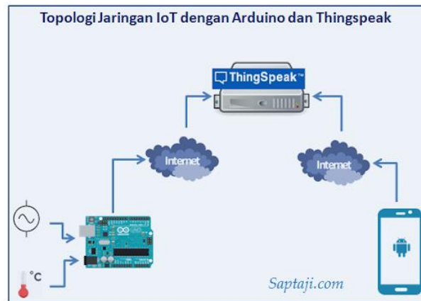
Gambar 2.6 Topologi Jaringan IOT Arduino dan Thingspeak
