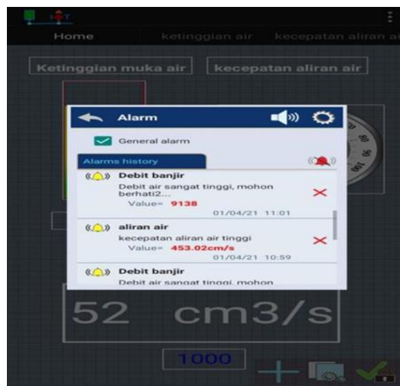
Gambar 4.11 Alarm Notifikasi Debit Banjir yang Tinggi
