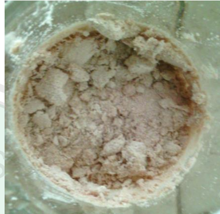
Gambar 2.3 Demineralisasi Khitin dari kulit Udang
