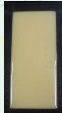
Gambar 3.4 Campuran khitin dan Polivinil Alkohol yang dilapiskan diatas Kaca
