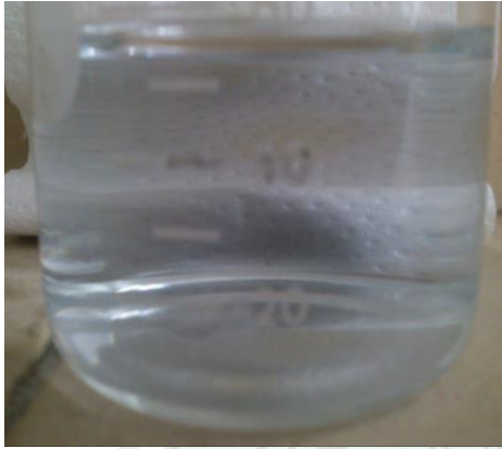
Gambar 2.2 Hasil pengujian Filtrat Deproteinasi terhadap Pereaksi Biuret
