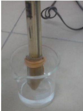
Gambar 4.1 pH meter (Ion Meter) yang telah telapiskan dengan Matrik Khitin dalam Larutan Urea
