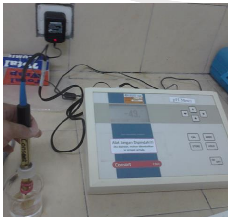
Gambar 5.1 Rancangan sel elektrokimia dengan menggunakan elektroda pH (ion meter)
