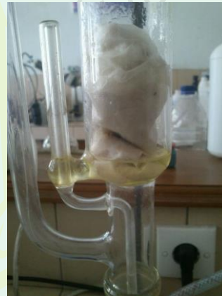
Gambar 2.5 Proses Penghilangan Warna dengan Metode Sokletasi Menggunakan Pelarut Aseton.
