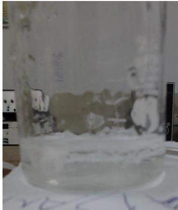
Gambar 3.1 Polivinil Alkohol dilarutkan dalam air demin pada perbandingan 1:10 (w/v) dengan suhu 100 °C
