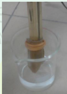
Gambar 4.8 pH meter (Ion Meter) yang telah dilapiskan dengan Matrik Khitin dalam Larutan Urea
