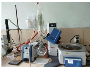
Proses rotav untuk menghilangkan pelarut aquades dengan tekanan pompa 800 dan suhu 60°C
