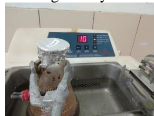
Proses ekstraksi ultrasonik selama 20 menit
