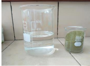
30 mg tepung kelor angin/jemur dengan aquades 300 mL dengan perbandingan 1:10
