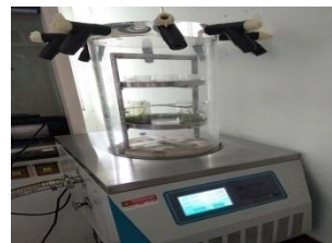
Proses freeze dry untuk menghilangkan pelarut aquades
