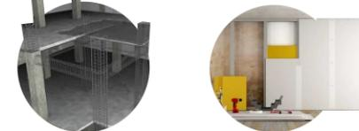
Struktur utama bangunan menggunakan sistem rigid frame yang mudah dan umum diterapkan dalam bangunan tinggi. Material dinding menggunakan dinding drywall dan beton fabrikasi untuk mencapai efisiensi pemasangan dalam skala besar.
