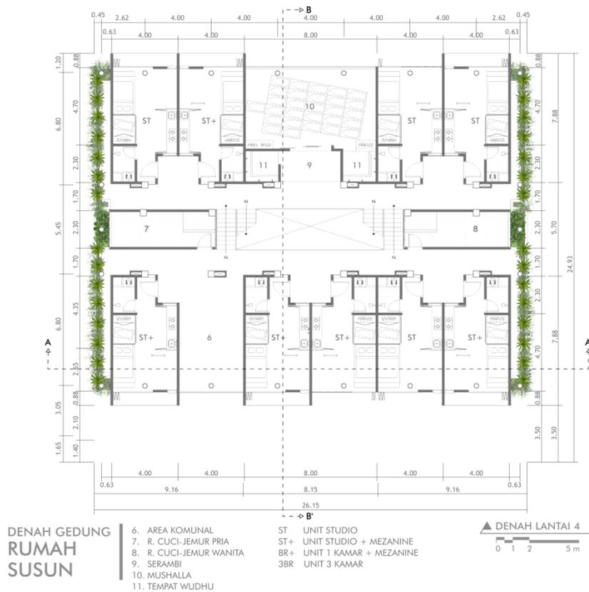
Gambar 6.42 Denah Rumah Susun Lantai 3 (atas) dan Lantai 4 (bawah)
