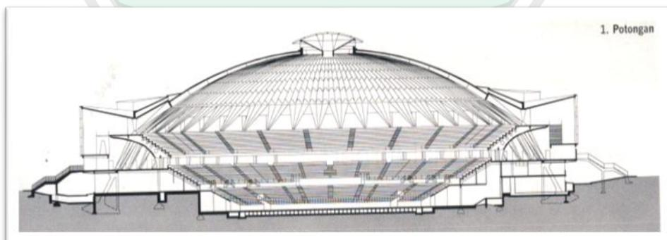
**Gambar 2.52 : Struktur Palazetto dello Sports**
