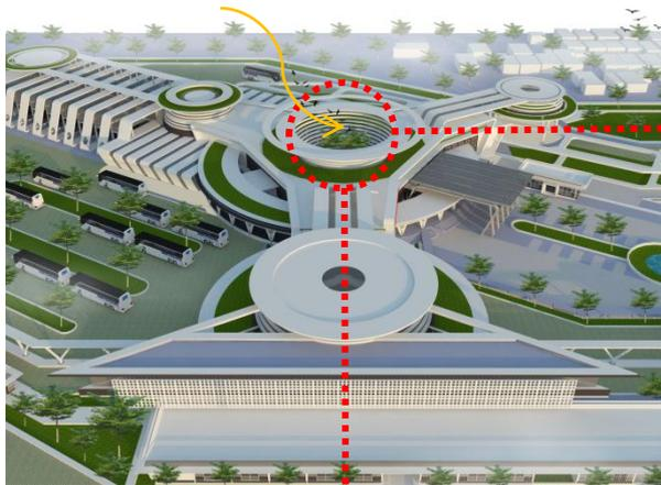
Gambar 6.8 Skema Distribusi Angin Pada Eksterior Bangunan
