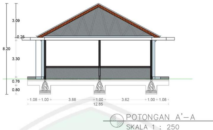
Gambar 6.17 Denah, Tampak, dan Potongan Bangunan Pertokoan
