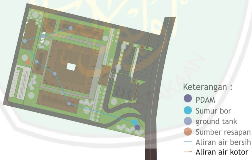
Gambar 4. 42 Analisis Sistem Utilitas (plumbing) Sumber: Analisis Pribadi, 2019
