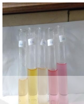
Hasil degradasi methyl orange variasi pH 2,5; 3; 4; 5; dan 6
