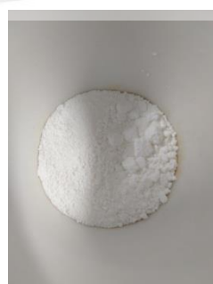
\text{TiO}_2\text{-N} setelah dikalsinasi
