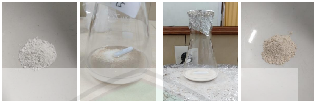
\text{TiO}_2\text{-N} dan zeolit dilarutkan dalam etanol
