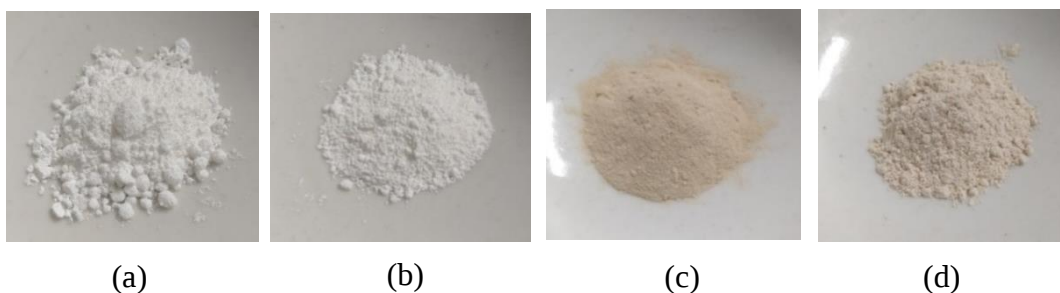
Gambar 4.4 Sampel (a) \text{TiO}_2 anatas; (b) \text{TiO}_2\text{-N} ; (c) zeolit; dan (d) \text{TiO}_2\text{-N/zeolit}
