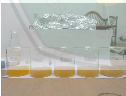
Hasil degradasi metil jingga variasi waktu penyinaran 40, 60, 80, 100, dan 120 menit
