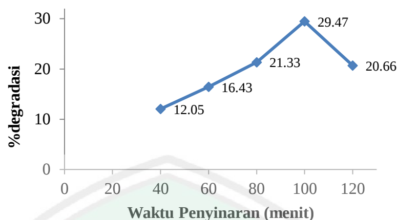
Gambar 4.12 Hasil uji aktivitas fotokatalis \text{TiO}_2\text{-N/zeolit} terhadap degradasi metil jingga dengan variasi waktu penyinaran
