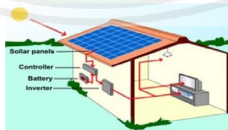
Gambar 2.59: panel surya pada bangunan (Sumber: )
