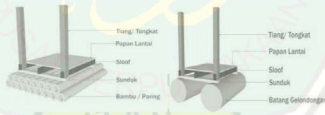
Gambar 2.11 : detail pondasi pada rumah lanting (Sumber: Daryanto, 2016)
