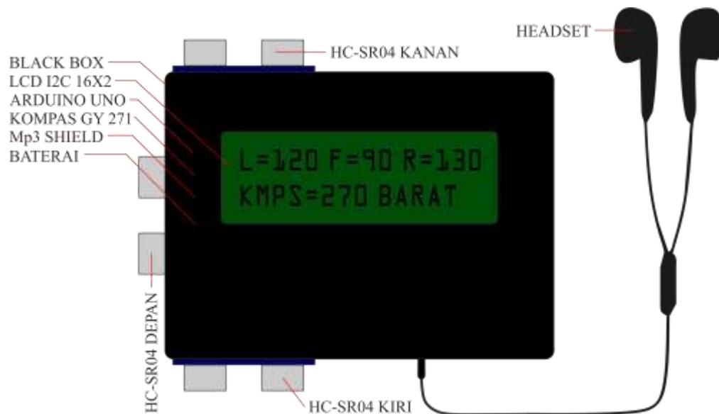
Gambar 3.3 Perancangan Mekanik Alat
