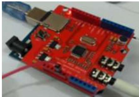
Gambar 4.6 Pemasangan MP3 *Shield* VS1053 pada Arduino Uno
