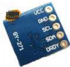
Gambar 2.10 Pin pada Modul Sensor GY 271
