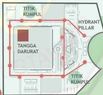
Sistem instalasi kebakaran, terdiri dari Hydrant pillar yang diletakan setiap jarak 30 m dan hydrant box pada setiap lantai bangunan pada tiap sisinya. Terdapat 2 area titik kumpul yang berada pada area terbuka dan berada strategis dapat dilihat banyak orang.
