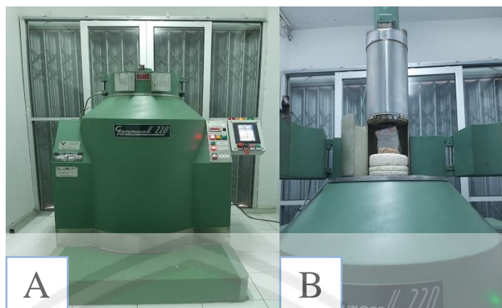
Gambar 3.3 Mesin Irradiator Gammacell 220 (A), Memasukkan Benih Ke Dalam Chamber Untuk Di Radiasi (B).
