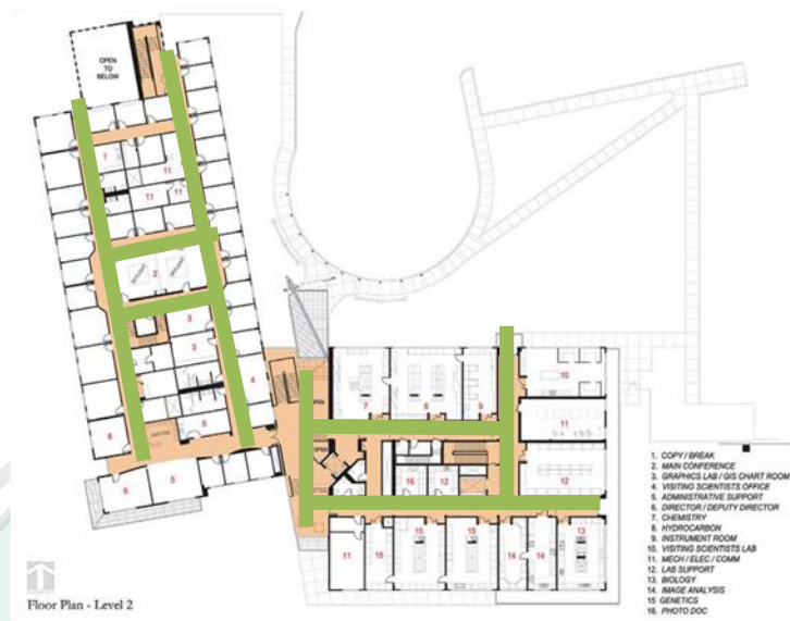
Gambar 2. 26 Sirkulasi dalam bangunan lantai 2
