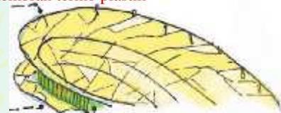
Menggunakan membran thermoplastik pada selubungnya, dipadu dengan sistem rangka MERO
