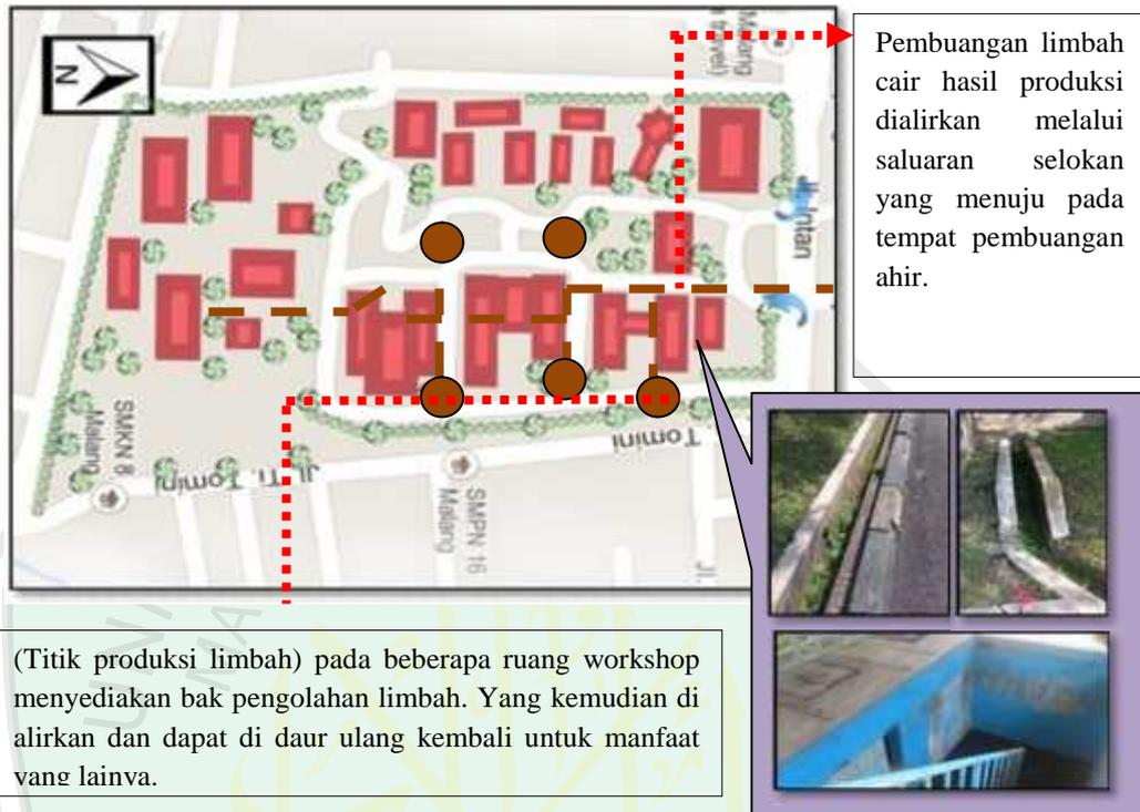
Gambar 2.52 aliran pembuangan limbah
