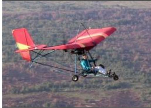
**Gambar 2.5:** Alat penerbang *ultralight Trike* dengan sistem kendali angin berada dibelakang, merupakan modifikasi dari alat terbang *Ultralight Trike Plans*.
