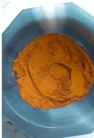
Gambar L.9.22 Endapan sebelum kalsinasi
