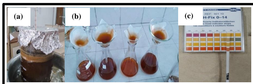
Gambar 4.4 Proses ekstraksi daun teh hijau dengan metode infusa, (a) pemanasan dengan suhu 80°C selama 30 menit, (b) penyaringan ekstrak daun teh hijau dan (c) hasil uji pH pada ekstrak daun teh hijau
