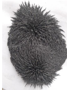
Gambar L.9.2 Limbah bubuk besi setelah preparasi
