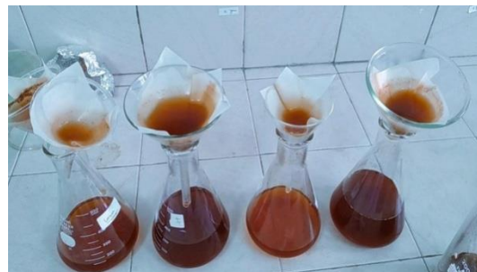
Gambar L.9.11 Penyaringan larutan teh
