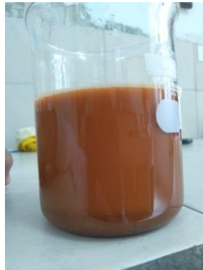
Gambar L.9.14 Larutan prekursor dalam 150 mL HNO 3 0,1 M
