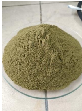
Gambar L.9.9 Daun teh hijau setelah di oven dan diayak 60 mesh
