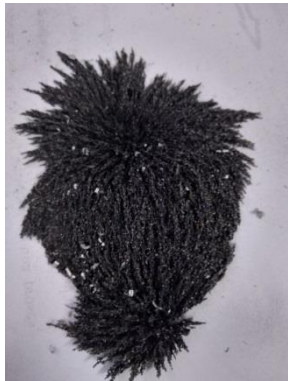
Gambar L.9.1 Limbah bubuk besi sebelum preparasi
