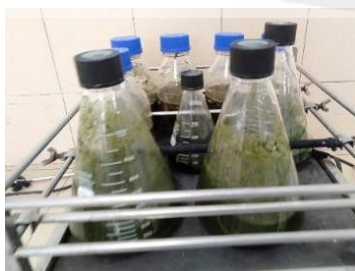
Proses ekstraksi maserasi + dishaker
