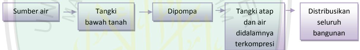
Gambar 4.23 Skema Alur Sistem Tangki Tekan
