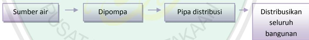
Gambar 4.24 Skema Alur Sistem Tanpa Tangki
