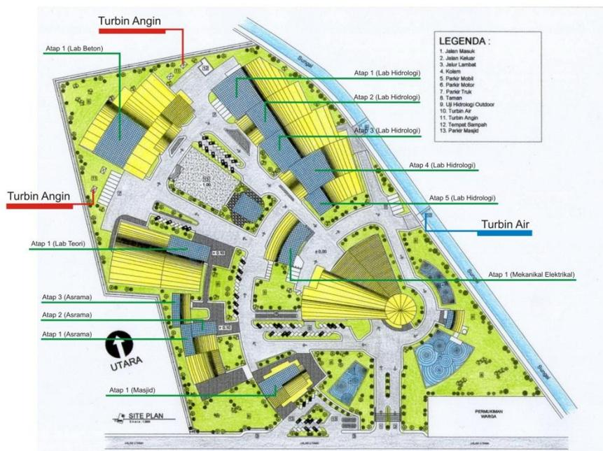
**Gambar 6.8. Penempatan Sumber Energi Listrik**
