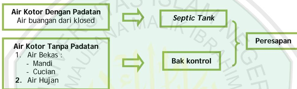
**Gambar 4.34. Analisis Sistem Pembuangan Air Kotor**
