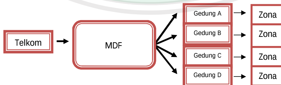
Gambar 6.55. Skema Sistem Jaringan Telepon (Sumber: Hasil Rancangan, 2012)
